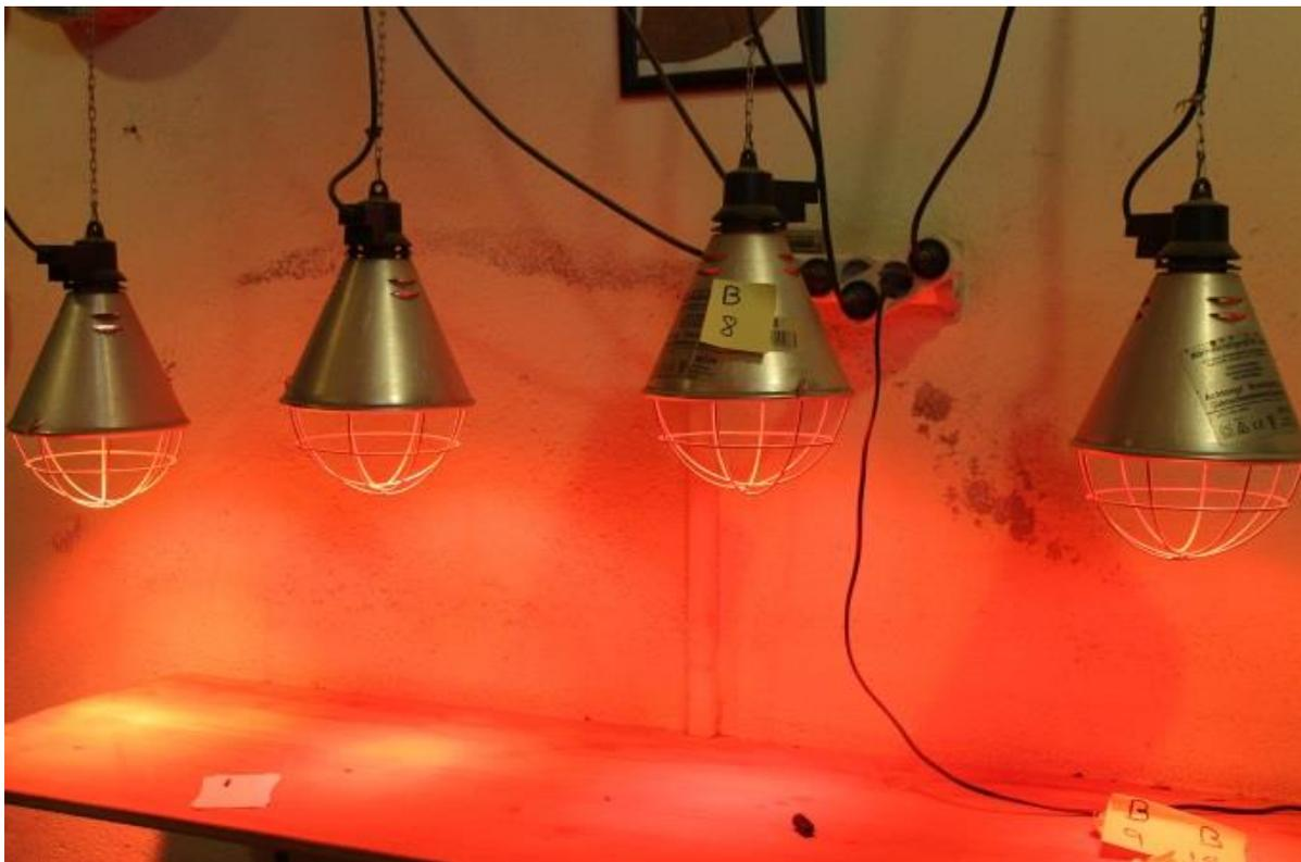
Imagem n.º 16 – Lâmpadas para Aquecimento e Secagem das Folhas de Tabaco/Tabaco Moído
